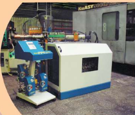
Установка подачи инертного газа (азота) в пресс-форму по технологии газодинамического удара
