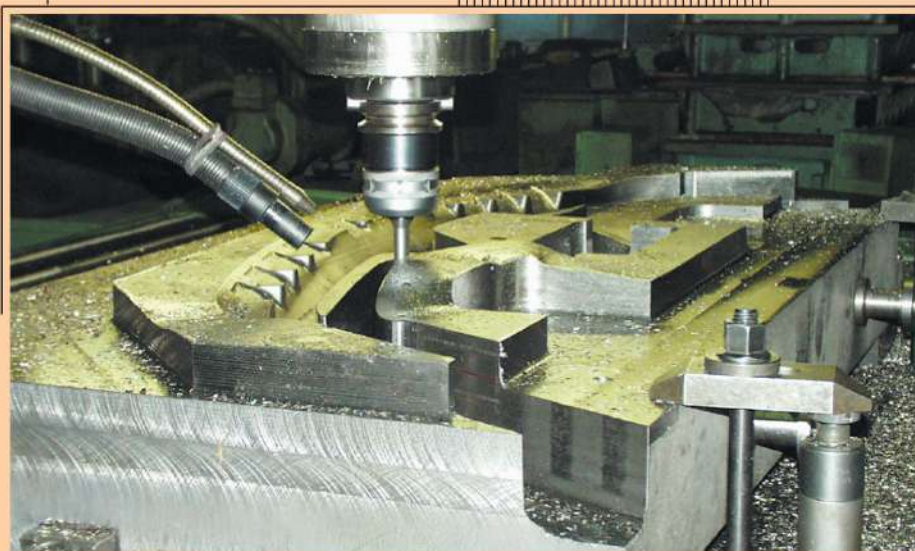
Обработка матрицы литейной формы на 3-х координатном обрабатывающем центре фирмы "KOLB"
