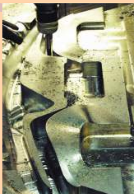
Обработка матрицы на станке фирмы "KOLB". Вес заготовки 50 000 кг
